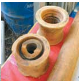
Wasserleitung mit innen glasierten Tonröhren
