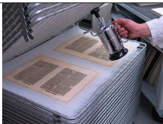
Abb. 14: Die geleimten und getrockneten Bogen werden befeuchtet
