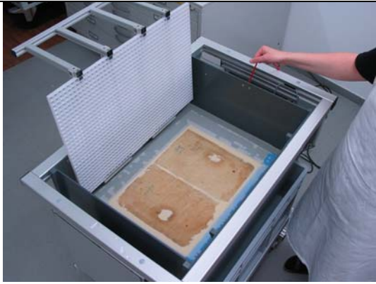
Abb. 23: Bogen im Anfasergerät nach dem „Schöpfvorgang“
