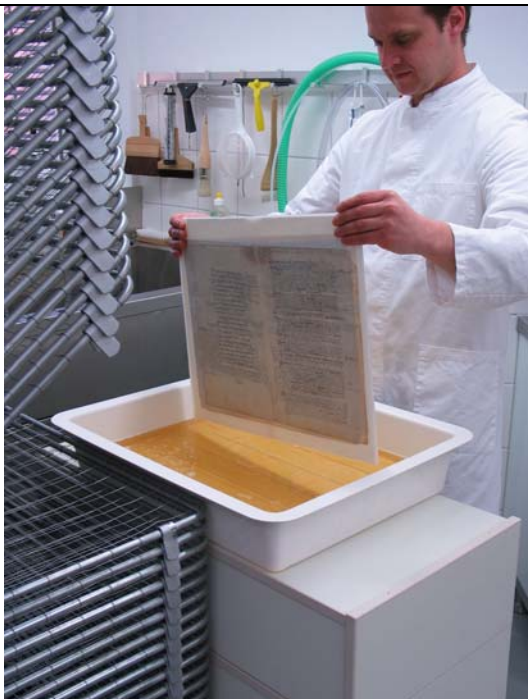
Abb. 11: Wässern der Papiere zwischen Trägervliesen – Abbauprodukte und Schmutz werden dabei ausgewaschen
